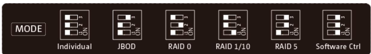
Sie können die RAID-Einstellungen manuell über die Modus-Taste auf der Rückseite des RAID-Gehäuses konfigurieren, indem Sie die Tasten in die entsprechenden Positionen bewegen, wie oben dargestellt.
